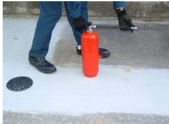
※持って操作するのが難しい場合は、地面に置いたまま上からレバーを押し下げるようにして操作する（右図）
